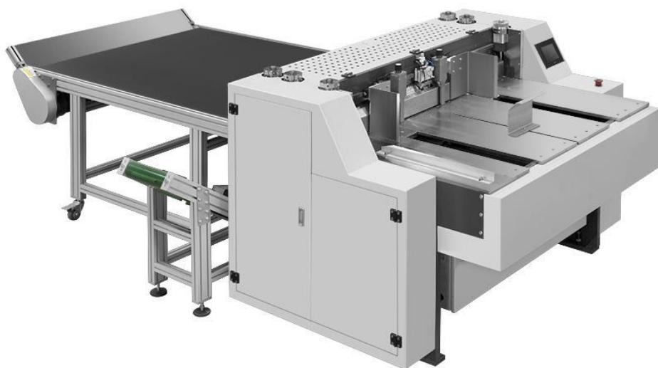
Réglage automatique numérique des disques de coupe et du format carton sur le margeur facilitant ainsi les réglages avec une grande précision.
