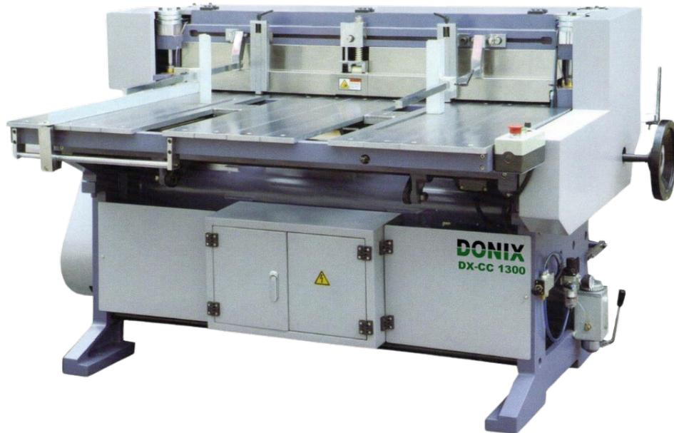
La découpeuse DONIX CC 1300 est généralement utilisée pour découper les cartons des couvertures en dure (classuer, livre, agenda...).
