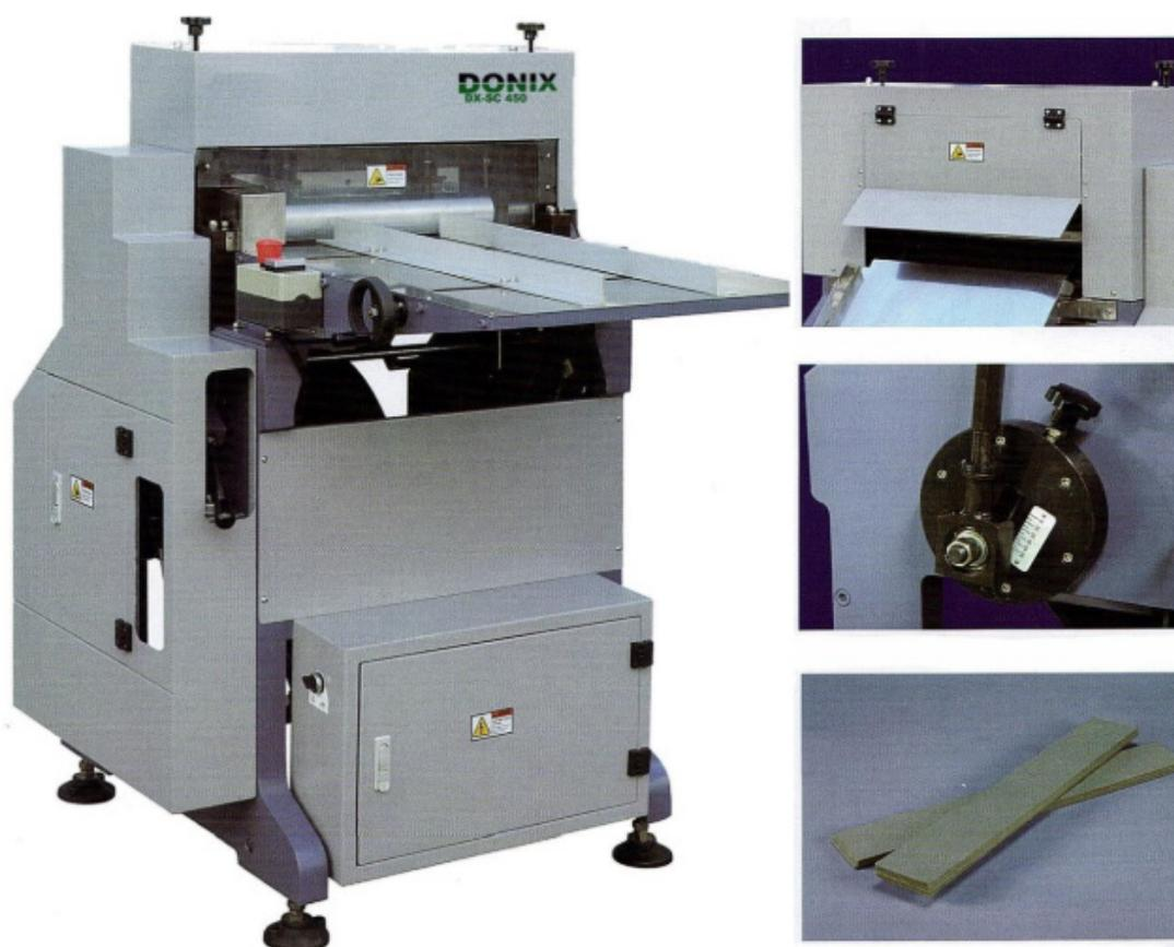
La découpeuse de dos SC 450 permet de produire rapidement et simplement des dos avec une qualité de production constante. Un moteur couplé un à un électroaimant déclenche une coupe rapide et puissante. Aux normes de sécurité CE.
