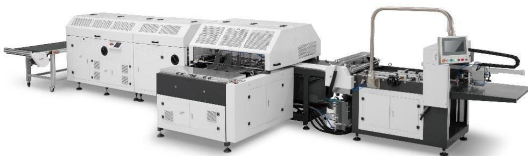
Le margeur carton peut déposer jusqu'à 6 cartons à la fois sur la feuille
