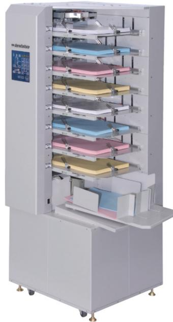
La nouvelle assembleuse de papier par aspiration à bande UCHIDA, modèle AeroCollate, peut assembler différents types de papier tels que les papiers offset, couchés, imprimés numériquement, etc. grâce à son système d'alimentation par aspiration à bande de conception unique.
