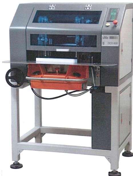
La DCR 400 est une machine compacte destinée à réaliser des coins arrondis de diamètre multiples sur des produits variés tels que des livres, des cahiers, des agendas, des cartes...
