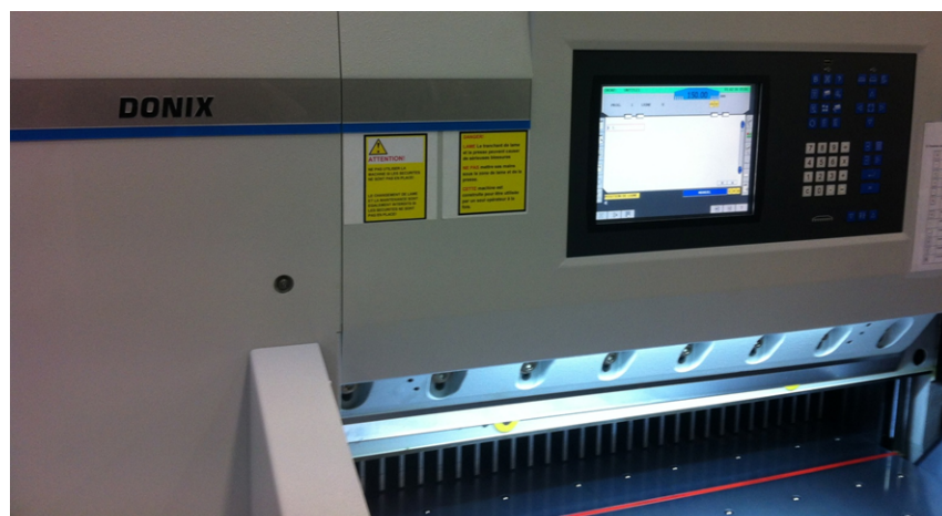
Changement de lame assisté avec dispositif de montage ultra-rapide (brevet Allemand)
