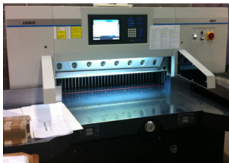
Plan de travail éclairé et ligne de coupe lumineuse
