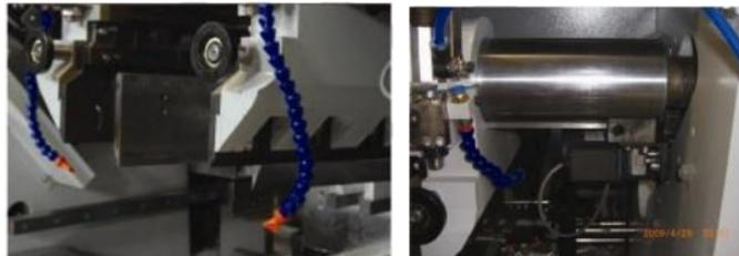
Des buses d'air sont installées à plusieurs endroits pour permettre l'évacuation des copeaux et de la poussière de papier pour une production parfaite.
