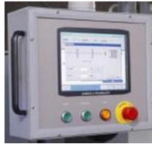
Un écran tactile de 10,4 pouce, permet de faire tous les réglages et de garder en mémoire les travaux qui reviennent souvent. Le temps de calage est ainsi donc diminué et cela limite également les erreurs humaines ! De plus un système d'autodiagnostic est intégré dans le programme !
