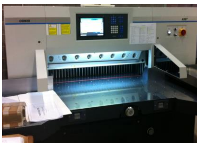
Equerre en fonte à double guidage / Plan de travail éclairé et ligne de coupe lumineuse / Capots arrières
