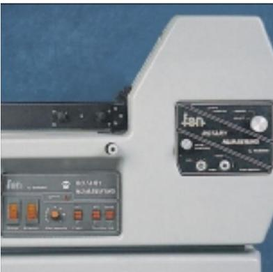
Les commandes sont centralisées pour faciliter l'utilisation. Les FRN5 et FSN disposent toutes deux d'un réglage de la pression du plateau. La position de numérotation peut également être réglée pendant le fonctionnement de la machine.
