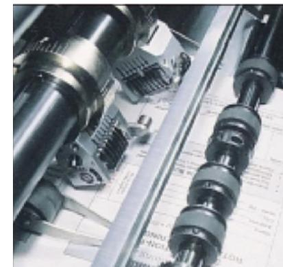
Un système de détection sophistiqué contrôle l'action de numérotation. Plusieurs têtes de numérotation peuvent être installées et les têtes convexes et parallèles peuvent fonctionner simultanément.
