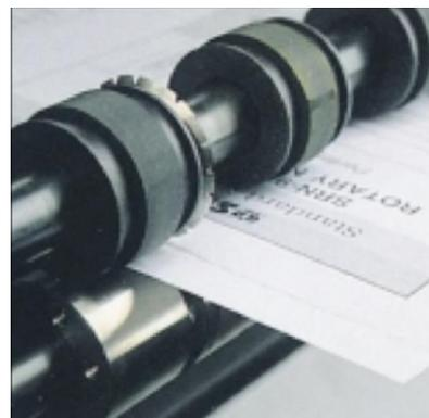
Les perforateurs de découpe permettent de réaliser des perforations plates sur une large gamme de produits. Différentes roues de perforation, de refente et de rainage sont disponibles.
