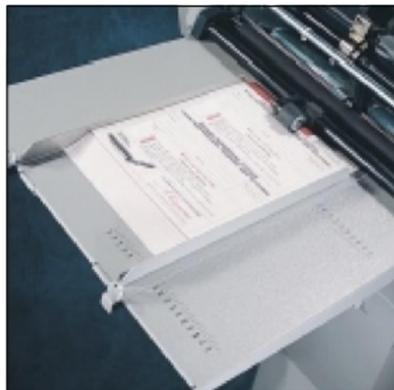
La technologie avancée d'alimentation pro-feed permet de charger des feuilles ou des jeux en cours de route. La FRN5 et la FSN alimentent les jeux avec un bord fermé ou ouvert.
