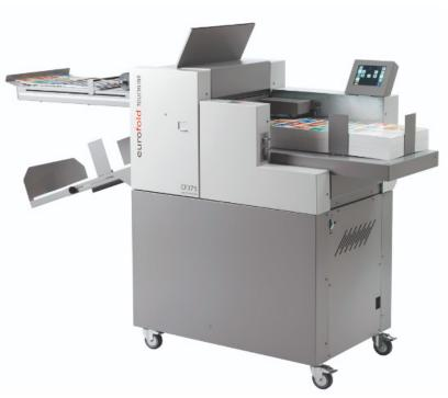
Le dispositif de pliage de la TOUCHLINE CF375 est équipé du système à couteaux breveté Multigraf Pro-Knife. Il permet non seulement d'obtenir un pli parfait mais évite les marques sur les feuilles. En utilisant cette technologie, TOUCHLINE CF375 marche à une vitesse appéciable de 6 000 feuilles A5 par heure, indépendamment du nombre de pliage et rainage.
