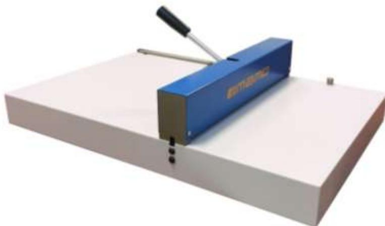
La raineuse MULTICOR 45 est un matériel professionnel prenant peu de place dans l'atelier et permettant de faire du rainage et de la perforation détachable. Elle est livrée avec 3 outils : 1 outil de rainage standard simple et double, 1 outil de rainage épais simple et double et 1 outil de perforation standard. Système de mesure de l'épaisseur des dos de livres.
