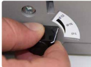
La jauge de profondeur permet à l'opérateur d'ajuster la marge du trou perforé de 2 mm à 4,5 mm (1). Cela renforce le bord de la reliure.
