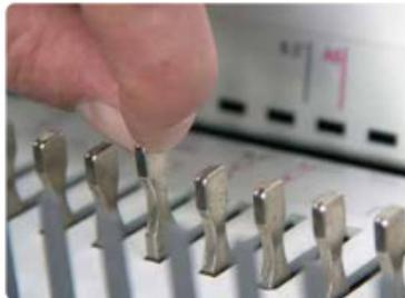
La technologie QSA (Quick Size Adjustment) permet d'annuler les pointes de perforation et de changer rapidement et facilement de format de papier (1).
