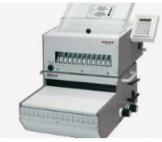
L'option WP 300, qui se trouve au-dessus de l'ECL 360, distribue automatiquement le fil du RENZ Wirepack lorsque l'on appuie sur la pédale de commande. Il s'agit du système de reliure par fil le plus automatisé disponible sur le marché.
