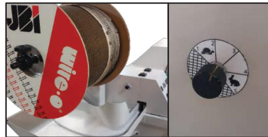
**Potentiomètre pour régler la vitesse de déclenchement de la bobine Wire-O® en douceur**
