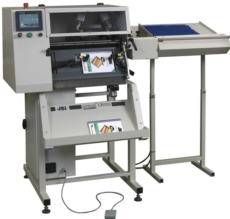
La CB3500 es una máquina semi-automática para la inserción de espiral plástica ideal para medias y grandes producciones con una productividad hasta 500 documentos / hora. La espiral plástica pre-formada puede ser alimentada a mano o mediante un módulo de alimentación que se conecta a la CB3500 para obtener una solución en línea desde una bobina de filamento formado con la CF5000. Esta configuración permite un control completo del proceso de acabado con la espiral plástica.
