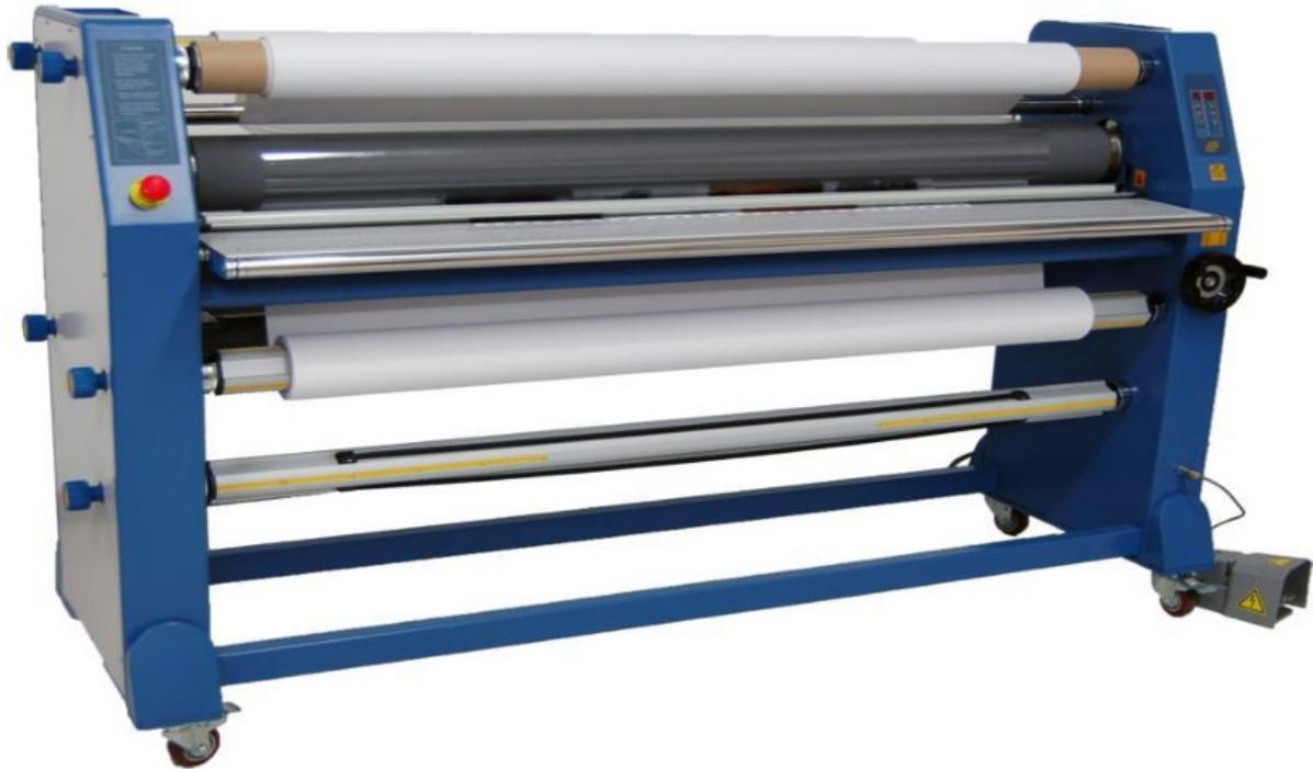
La CALA 160H est une plastifieuse grande laize utilisée pour la plastification de plans et autres documents de grands formats. Simple d'utilisation, équipée d'un cylindre supérieur chauffant, elle permet une application de la plastification sur les supports difficiles.
