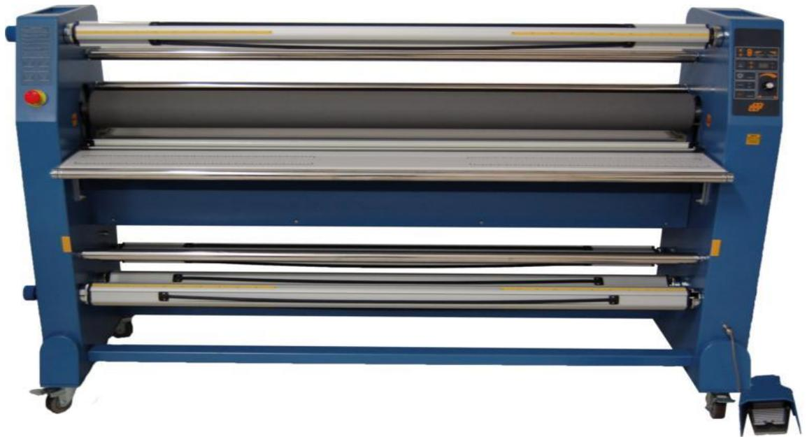
La CALA 160XP est une plastifieuse et une pelliculeuse une face de grande laize utilisée pour la plastification ou le pelliculage de documents de grands formats. Simple d'utilisation, équipée d'un cylindre supérieur chauffant réglable jusqu'à **150°C** et d'un panneau de contrôle complet pour ajuster avec précision tous les réglages. C'est une machine complète qui vous permettra de réaliser la plupart de vos travaux. Pression automatique réglable.
