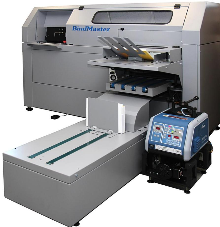
*Le Bindmaster utilise de la colle PUR avec un réservoir maxi. de 4 Kg
