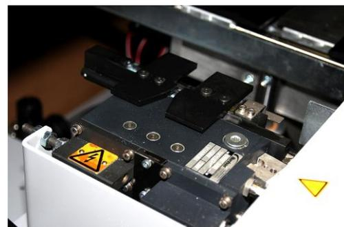
*Sortie motorisée sur le dos en option et système d'encollage Nordson*
