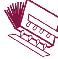
4. Application de la PUR sur le dos et les côtés par la buse
