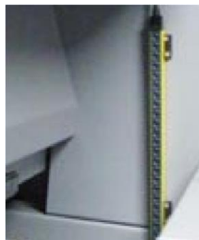
Cellule de protection et permettant également le démarrage automatique du chariot en mode auto
