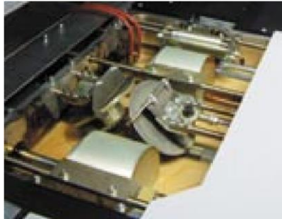
Section d'encollage EVA, disposant de 2 cylindres d'encollage du dos et de 2 disques d'encollage latérale
