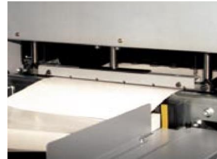
Margeur automatique à succion avec rainage des couvertures par emboutissage (maxi. 15 rainages/couv)
