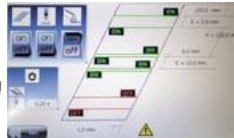
Margeur automatique à succion avec rainage des couvertures par emboutissage (maxi. 15 rainages/couv)
