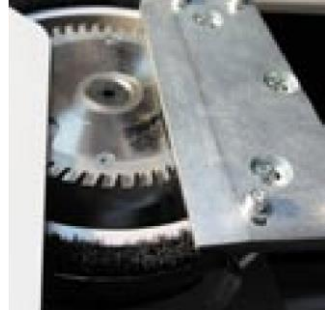
Section de fraisage et de grecquage réglable en hauteur jusqu'à 3mm
