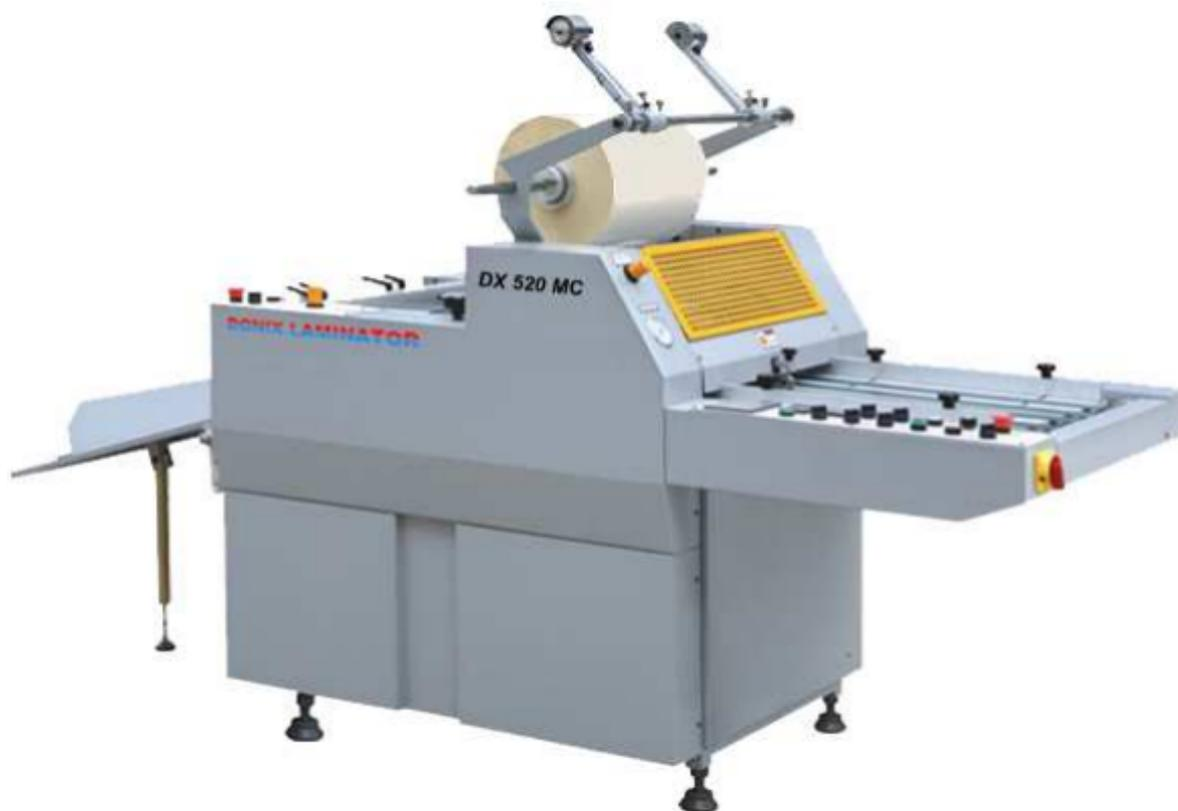
La pelliculeuse DX 520 MC est à marge manuelle, elle est équipée d'un système de séparation en sortie et les réglages se font à l'aide de l'écran tactile.
