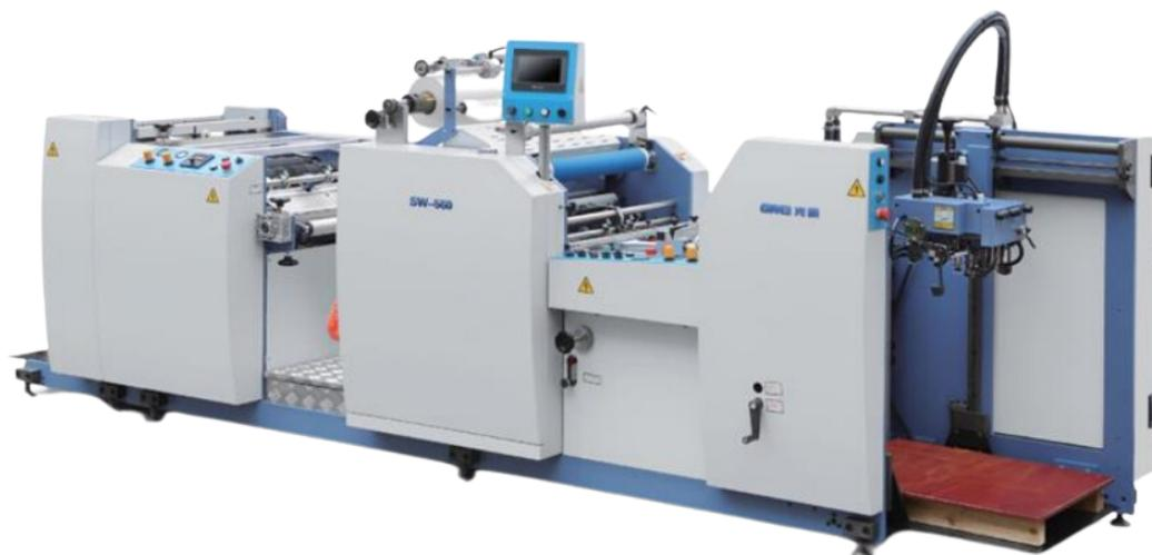
Cette pelliculeuse professionnelle vous permettra de réaliser des travaux avec une qualité irréprochable en un temps record grâce au système de chauffe du cylindre par induction électromagnétique.
