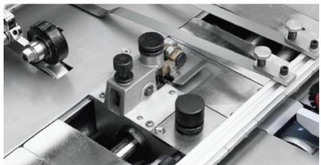
Système automatique d'alignement des feuilles avec servo-controler
