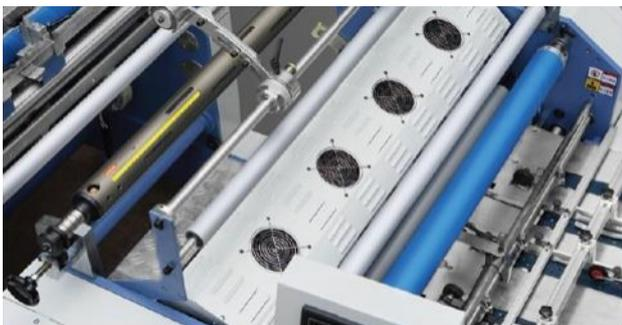
Chauffe en 1m30 du cylindre par induction électromagnétique.
