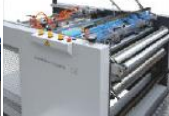
Margeur haut de pile / Sortie haut de pile avec taquage Séparation pneumatique
