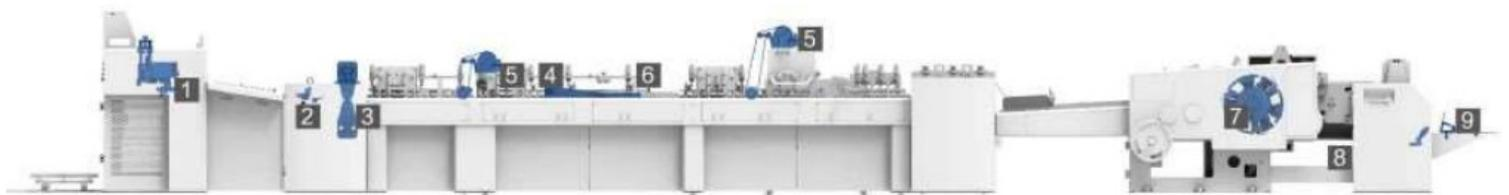
1. Alimentateur : l'alimentateur de papier à empilement préalable amélioré permet d'alimenter le papier en continu, ce qui réduit considérablement le temps nécessaire au chargement et à l'ajustement du papier brut.
