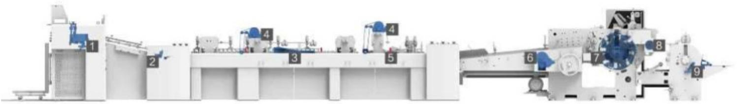
1. Alimentateur : l'alimentateur de papier à empilement préalable amélioré permet d'alimenter le papier en continu, ce qui réduit considérablement le temps nécessaire au chargement et à l'ajustement du papier brut.
