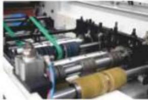
Système de pré-creusage sur le corps du sac par servo-moteur.
