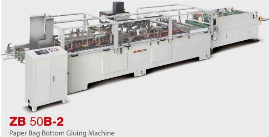
La machine à coller les sacs en papier ZB50B-2 est notre modèle amélioré qui adopte un système de colle thermofusible (4 buses de pulvérisation). Chaque buse de pulvérisation peut ajuster la longueur et l'épaisseur de l'encollage indépendamment ou travailler de manière synchronisée. Avec l'unité de pressage optionnelle, vous obtiendrez des sacs en papier sans trace d'une qualité parfaite que vous ne pouvez pas imaginer.
