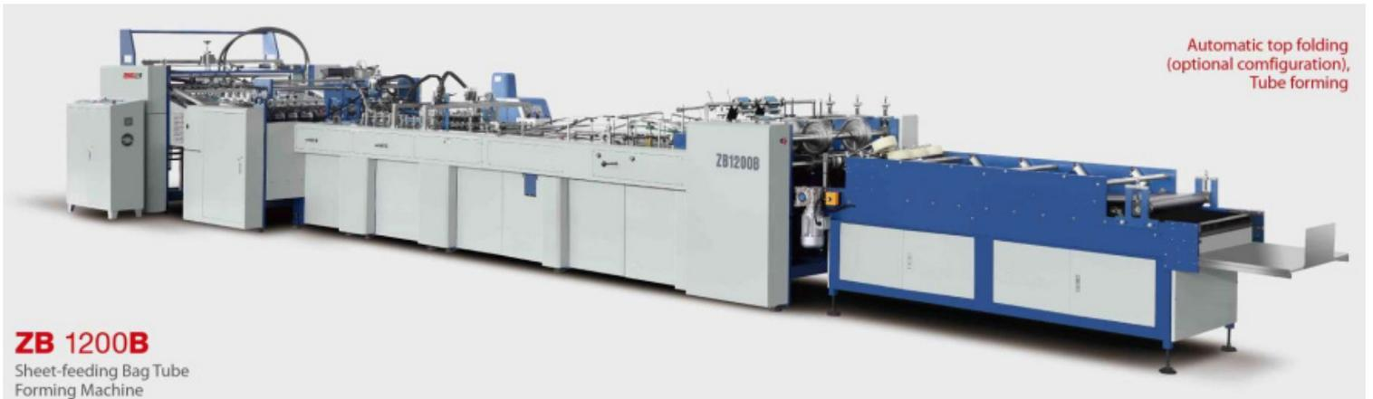
La machine de formation de tubes de sacs en papier ZB 1200B est adaptée à divers types de papier froissé, y compris le papier verni, le papier laminé et d'autres techniques de traitement, pour fabriquer des sacs en papier de haut niveau et de produits de luxe.
