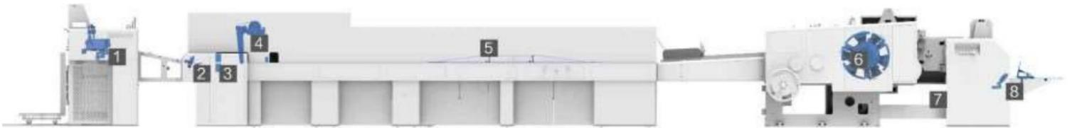
1. Alimentateur : l'alimentateur de papier à empilement préalable amélioré permet d'alimenter le papier en continu, ce qui réduit considérablement le temps nécessaire au chargement et à l'ajustement du papier brut.
