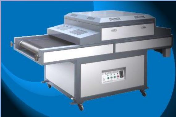
Le four UV permet un séchage rapide des encres UV en profondeur. Il est équipé d'un tapis motorisé et de deux lampes UV. Un pupitre permet de régler la puissance des lampes
